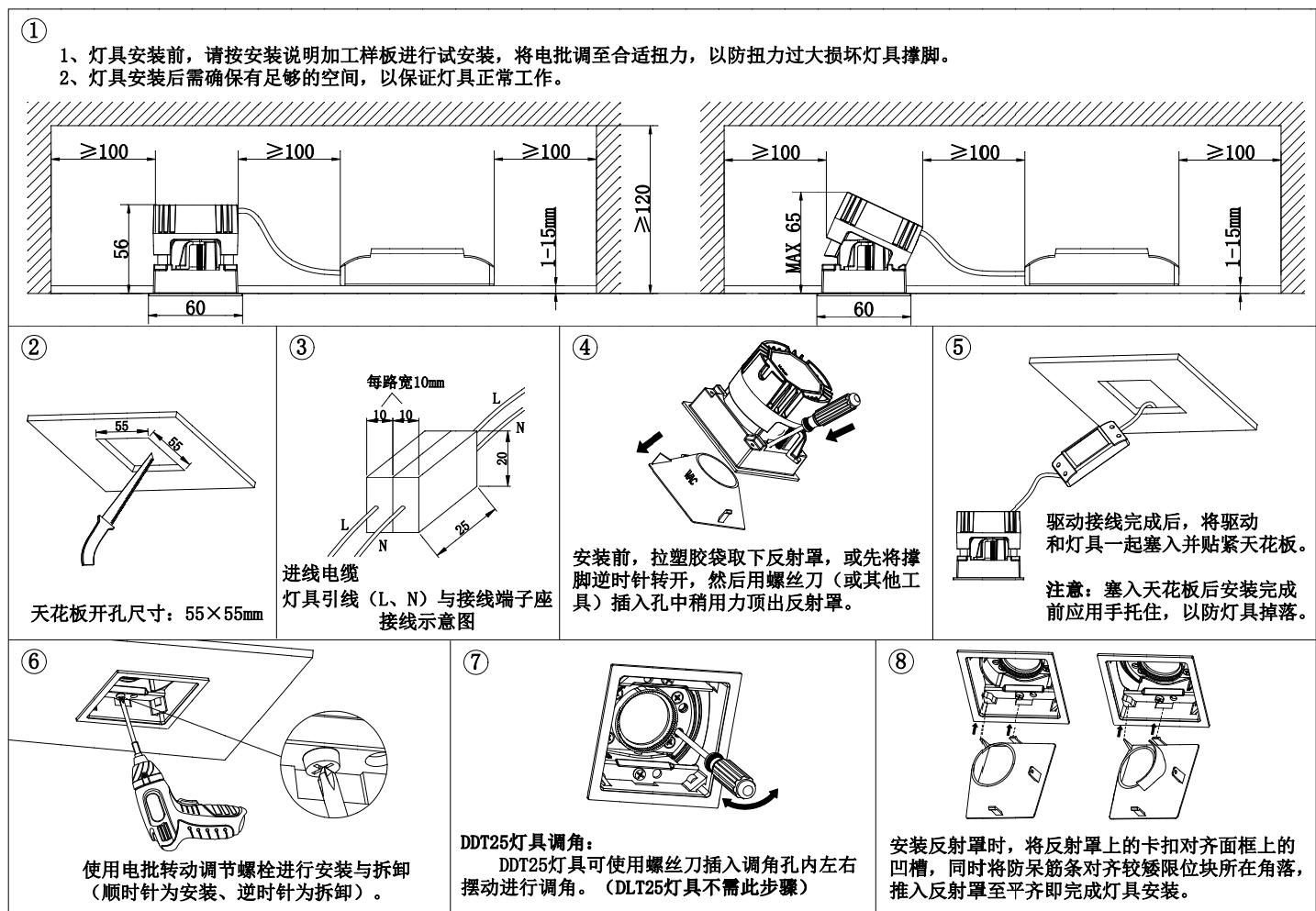
\* 若灯具的电器自带引线，且此连接引线需要与一个独立的接线端子座进行连接（参考图3示意图接线），每路接线端子座尺寸应不小于10x20x25mm。
