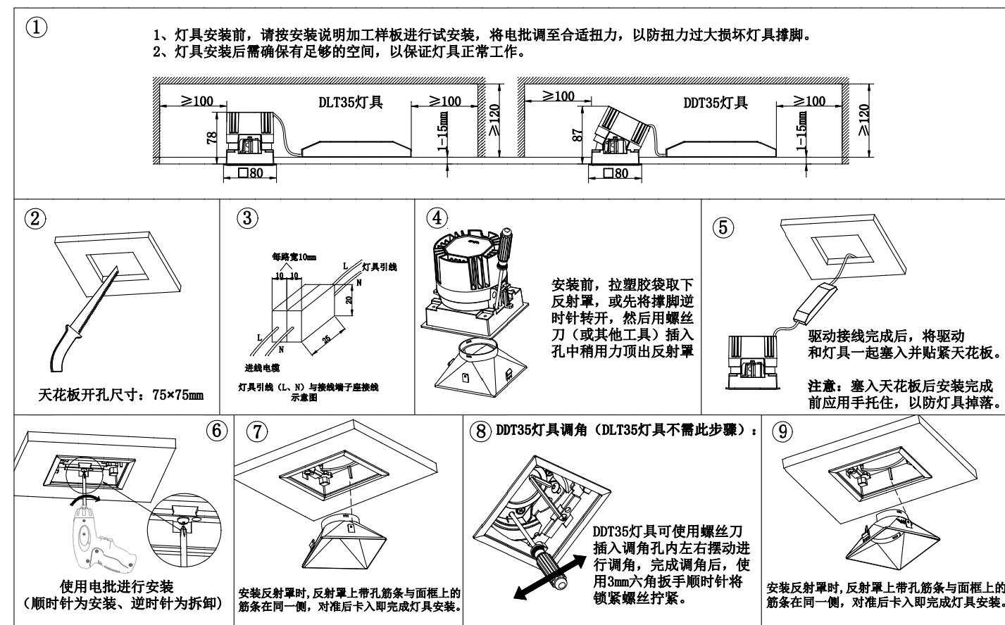
\* 若灯具的电器自带引线，且此连接引线需要与一个独立的接线端子座进行连接（参考图3示意图接线），每路接线端子座尺寸应不小于10x20x25mm。
