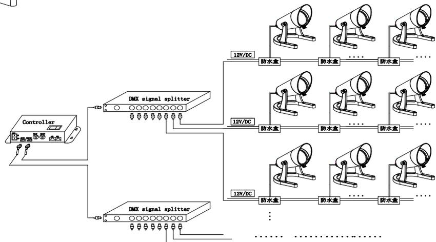
4. 将灯具各线芯分别与电源输入 (12V/DC) 及信号输入线匹配并接好;
