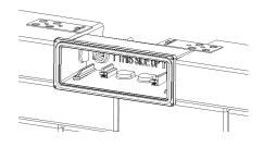
6. 模组与安装好的灯身接线,火线接火线, 零线接零线,地线接地线。
