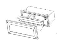
2. 把直径 6-8mm 的圆形防水线从灯身防水接头穿过,内部保留 150-200mm 的内部接线,锁紧防水接头螺母。
