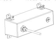
6. 模组与安装好的灯身接线,火线接火线, 零线接零线,地线接地线。
